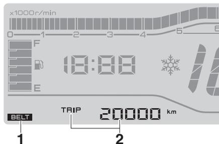
1. Indicateur de remplacement de la courroie trapézoïdale "BELT"
