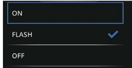
Wählen Sie “ON”, damit die Anzeige bei der Enddrehzahl aufleuchtet. Wählen Sie “FLASH”, damit die Anzeige bei der Anfangsdrehzahl zu blinken beginnt. Wenn die Enddrehzahl erreicht ist, beginnt die Anzei-
