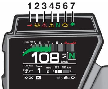
1. Anzeigeleuchte des Wegfahrsperrsystems "🔑"
