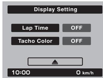
Mit diesem Modul können der Rundenzeitmodus und der Farbmodus des Drehzahlmessers ein-/ausgeschaltet werden.
